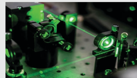
▲ Alignement laser des lentilles
