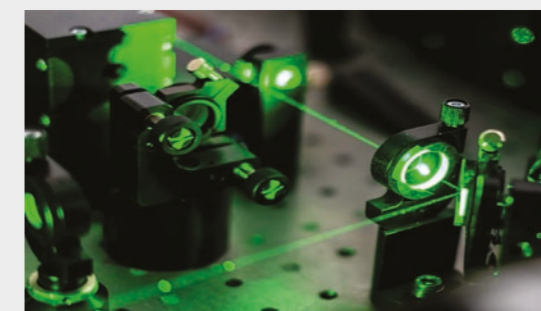
▲ Alignement laser des lentilles
